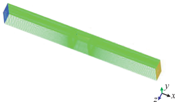
图 4 外流场计算域结构化网格划分 Fig. 4 Mesh generation of external-flow-field computational domain
