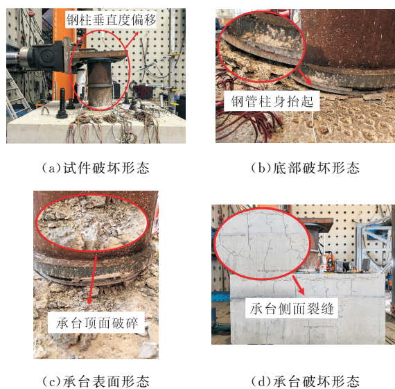
图 7 CFST 试件破坏现象
