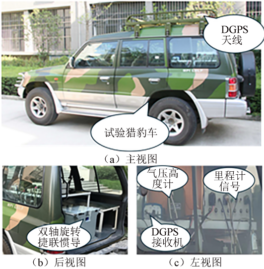
图4 重力测量系统 Fig. 4 Gravity measurement system
