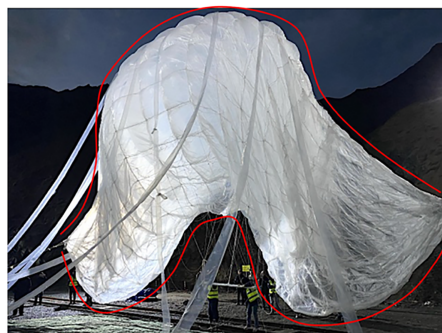
图9 聚乙烯飞艇非成形发放形状
