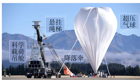
图 2 高空气球系统组成结构
