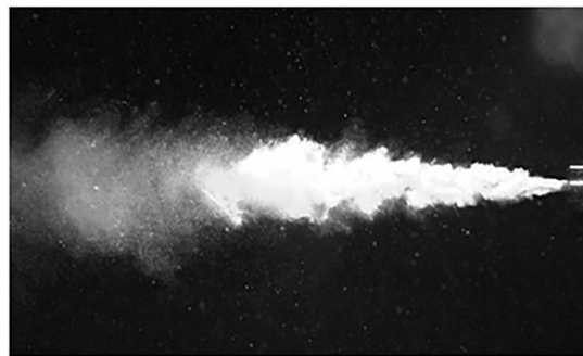
图 1 高速摄像机拍摄的水力空化射流图像
