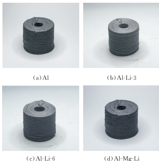
图 3 增材制造的固体推进剂样品
