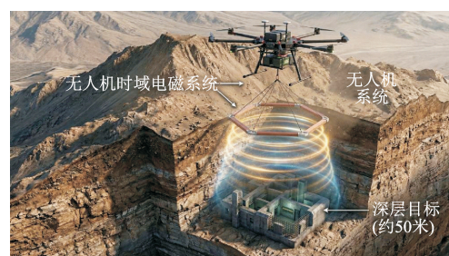
图 4 航空时域电磁法场景示意
